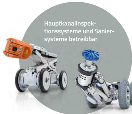
Mit dem LISY-System ist es möglich, während des Inspektionsvorgangs Verlaufs- und Lagemessungen durchzuführen.
