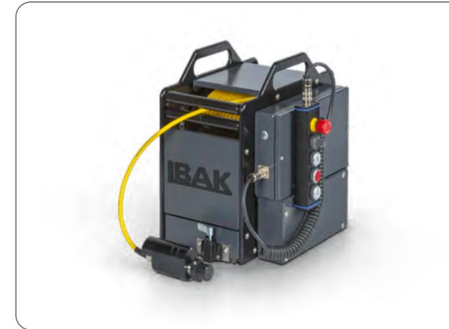
Die Kabelwinde **KW SI** ermöglicht flexible Einsätze mit der Schachtkamera PANORAMO SI 4K. Die Winde kann platzsparend in ein Fahrzeug eingebaut, aber auch an einem mobilen Gestell mit Laptop eingesetzt werden. Sie vereint die Vorteile eines mobilen Systems mit denen einer kompakten eingebauten Anlage für eine effiziente Schachtspektion aus dem Fahrzeug heraus.
